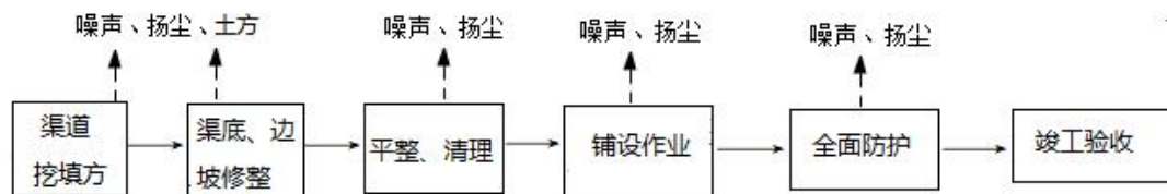
图 3-3-4 渠道护砌工程施工工艺流程及产污环节图
