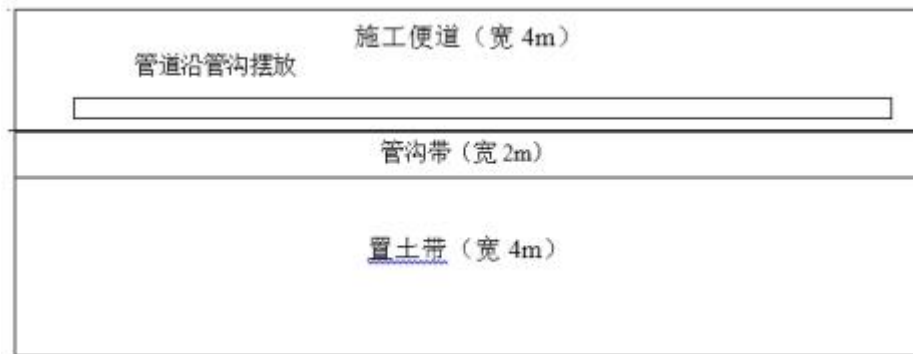
图 3.8-5 管道开挖施工平面布置示意图
