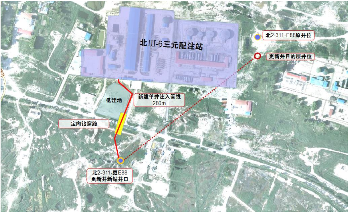
图 6.3-2 北 2-311-更 E88 注入单井井位示意图
