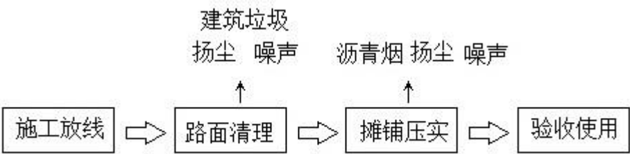
图3.12-10 道路维修改造施工工艺流程图
