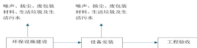
图 3-1 本项目施工期工艺流程图及产污节点
