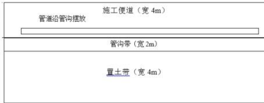
图 3.8-5 管道开挖施工平面布置示意图
