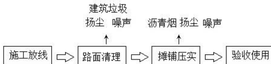
图3.8-8 道路施工工艺流程图
