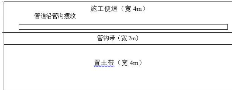
图 3.12-4 管道开挖施工平面布置示意图
