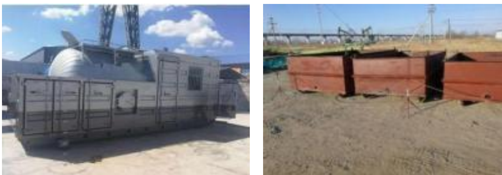
图 4-33 作业现场污水回收装置及污油污水收集槽
