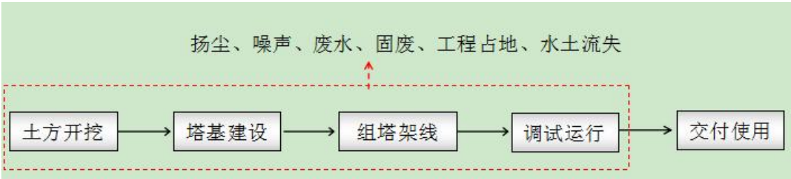
图 4-2 集电线路施工工艺流程图
