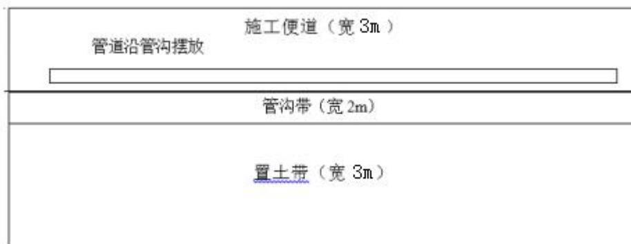
图 3.7-3 管道开挖施工平面布置示意图
