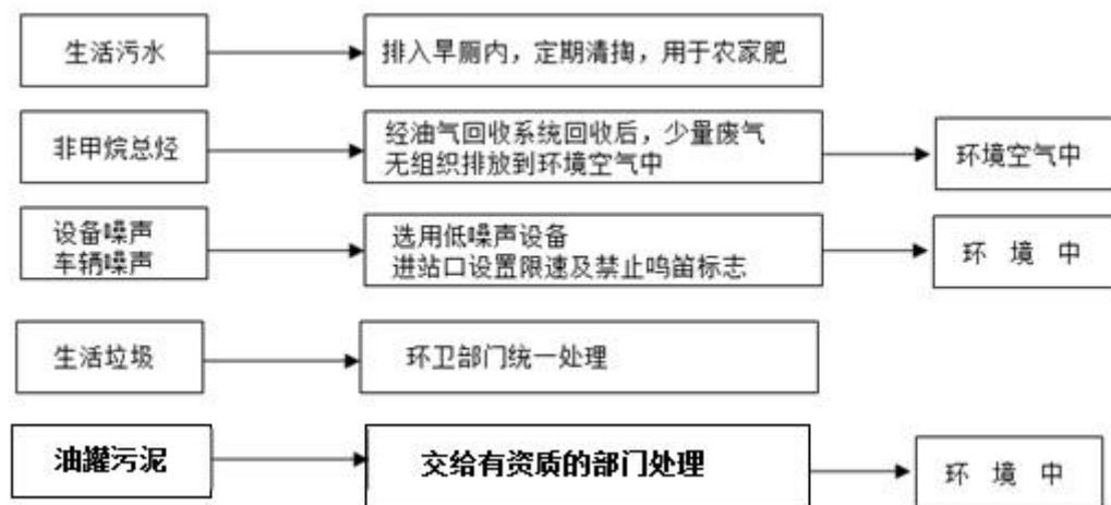
图 6 污染物排放流程示意图
